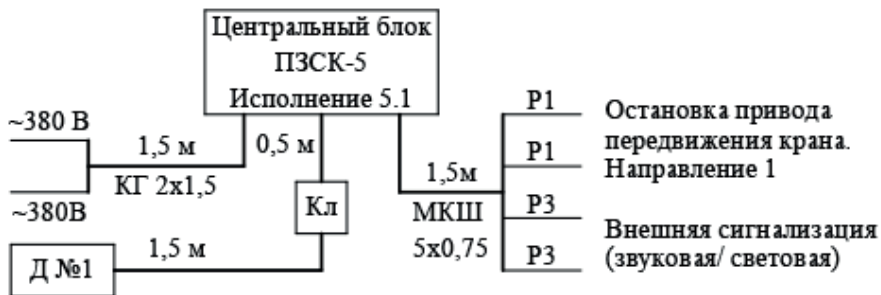
Рис. 1 Структурная схема ПЗСК-5.1
