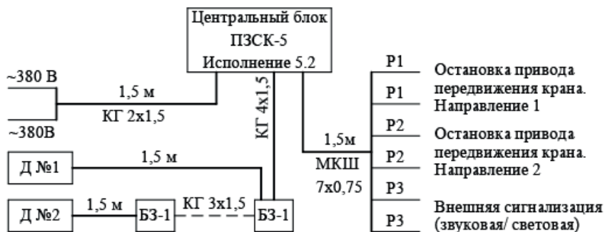
Рис. 2 Структурная схема ПЗСК-5.2
